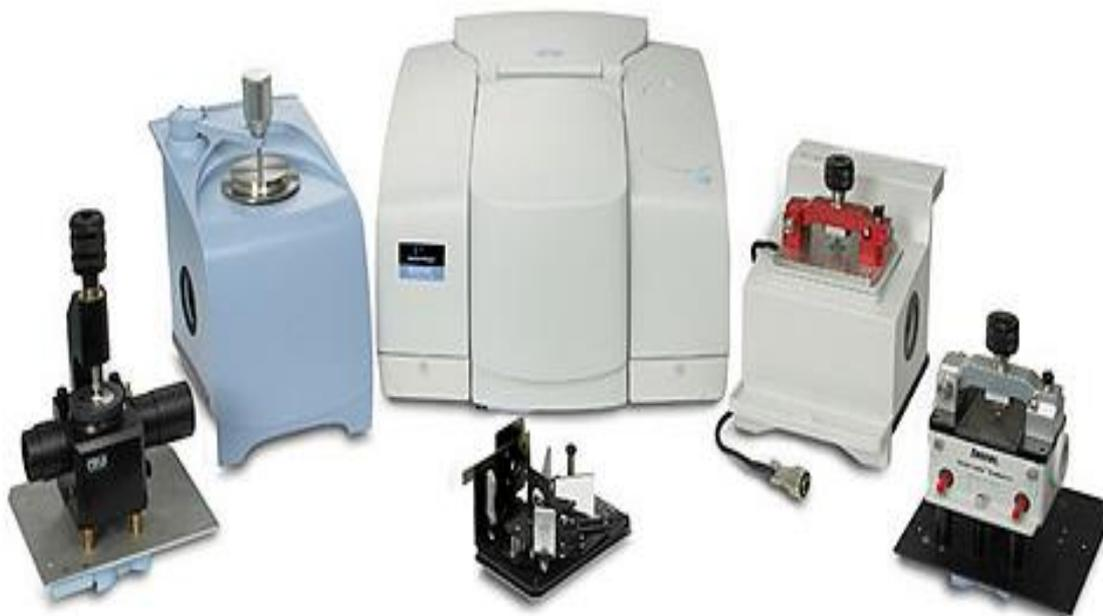
Рисунок 12 - ИК спектрометр Spektrum-65
